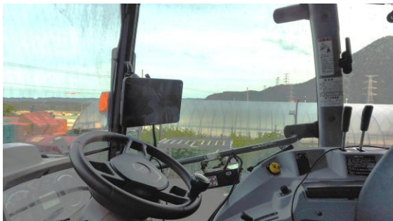
自動操舵システムを導入したトラクター
