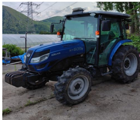
自動操舵システムを導入したトラクター
